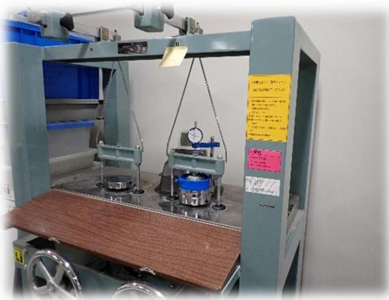
地盤材料の圧密試験の様子
